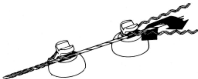
**4.** Siga o mesmo procedimento para aplicação da segunda peça do Laço Lateral Duplo, com esta exceção: se na primeira peça você aplicou a primeira perna do Laço sob e por volta do coxim então, na segunda peça você deverá aplicar a primeira perna sobre e por volta do coxim (ou vice-versa).
