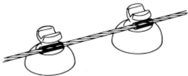
**1.** Coloque o coxim no condutor e em contato com o centro do pescoço do isolador. A abertura do coxim deverá ficar para fora, conforme indicado.
