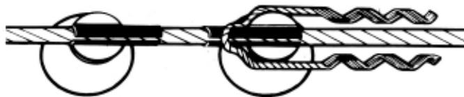
**2.** Coloque o Laço Duplo Preformado sobre o condutor e isolador, conforme indicado. Certifique-se de que o condutor e pescoço do isolador estejam entre as pernas do Laço.
