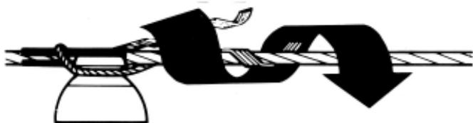
**3.** Assente as pernas do Laço em volta do pescoço do isolador e aplique uma das pernas com várias voltas sobre o condutor. A direção de encordoamento das pernas do Laço deverá ser a mesma do condutor.
