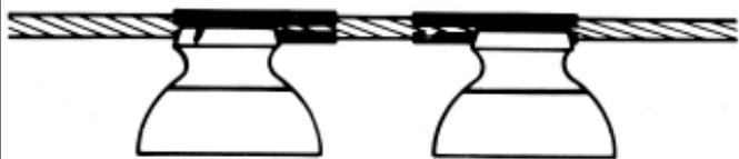
**1.** Aplique os coxins sobre o condutor com as aberturas para o lado, exatamente conforme indicado na figura.
