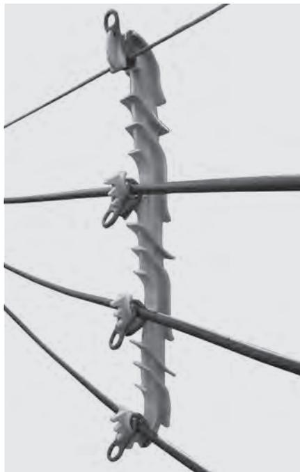
Acessório de formato vertical para utilização em Redes Compactas classe de tensão 5 kV. Apoiado sobre um cabo mensageiro, sua função é a sustentação e separação dos cabos cobertos nas conexões no vão (flying-tap), mantendo o isolamento elétrico da rede.
