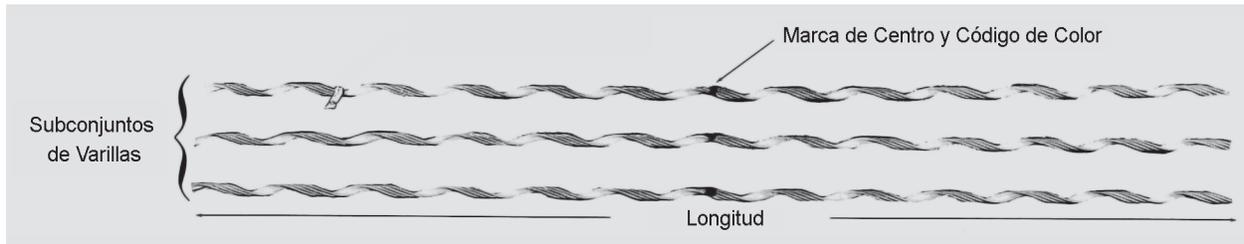
Producto preformado destinado a la reparación mecánica de los hilos de la corona externa de los cables OPGW.
