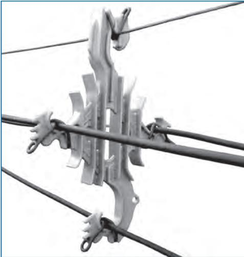
Accesorio de formato poligonal para utilización en líneas compactas clase 35 kV. Colgado de un cable mensajero, su función es la sustentación y separación de los cables protegidos a lo largo del vano, manteniendo la aislación eléctrica de la línea.
