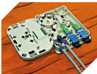
Conexão c/ Cabo Drop
