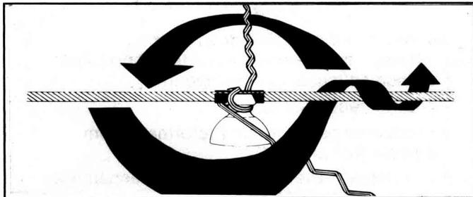
3. Gire el amarre 180°, pasando sus piernas por debajo del conductor y encajándolas en el cuello del aislador hasta que ellas queden nuevamente paralelas al conductor.
